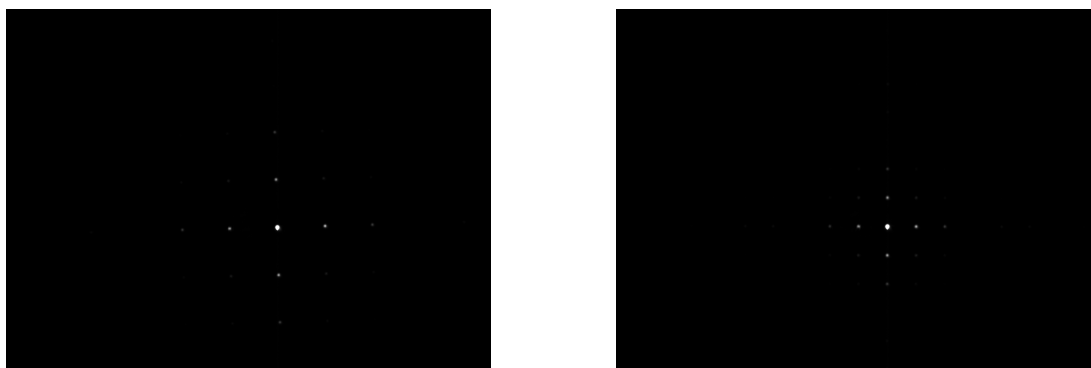
Obrázek 27: Difraktogramy pořízené na mřížkách s různě velkými periodami.
