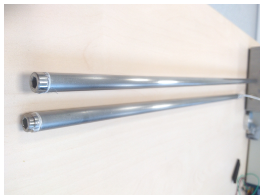
Obrázek 13: Referenční teplota byla měřena pomocí platinového čidla připojeného k 24 bitovému převodníku se zdrojem proudu. Zapouzdření platinového čidla i šumového teploměru bylo záměrně provedeno stejným způsobem.
