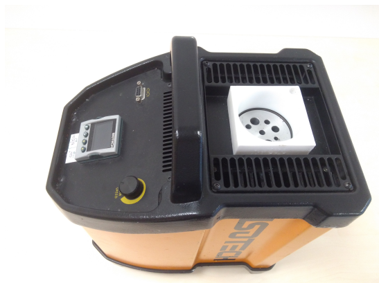
Obrázek 12: Kalibrační pec Isotech Hyperion 4936 obsahuje displej, který zobrazuje nastavenou a aktuální teplotu, ale pro přesná měření bylo vhodnější použít nezávislý teploměr.
