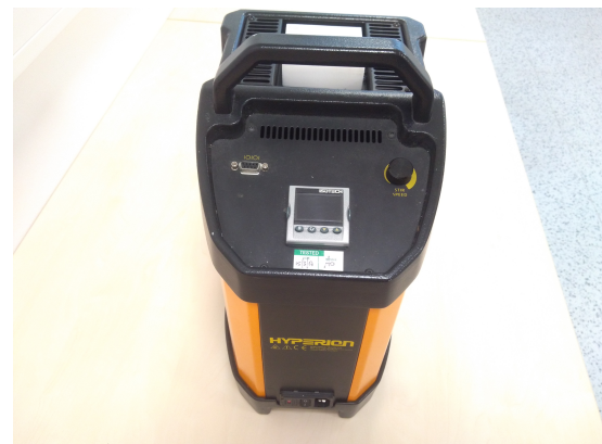
Obrázek 12: Kalibrační pec Isotech Hyperion 4936 obsahuje displej, který zobrazuje nastavenou a aktuální teplotu, ale pro přesná měření bylo vhodnější použít nezávislý teploměr.
