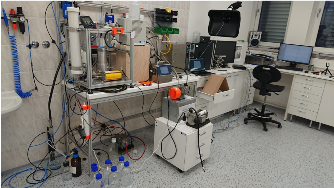
Obrázek 5: Aerosolová aparatura ČMI Brno na stole uprostřed snímku. Zleva: DMA od ÚChP AVČR, kondenzační čítač TSI 3772, optický čítač TSI AeroTrak 9310, SMPS systém Grimm.
